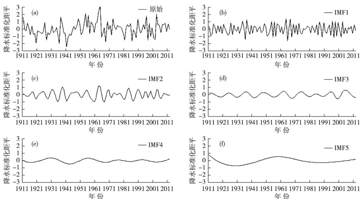
图 8 1911—2012 年黄淮海地区年降水量标准化距平序列集成经验模态分解 IMF 分量 (IMF1—IMF5) 时间变化
