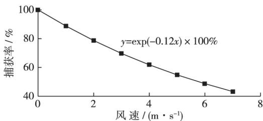
图 10 中国东北地区冬季日平均风速与雨量计降雪捕获率的关系
